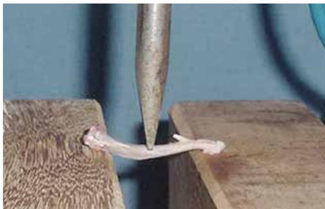
Figura 1. Aspecto da máquina Universal de ensaios mecânicos com o corpo de prova montado para ensaio de flexão em três pontos.
